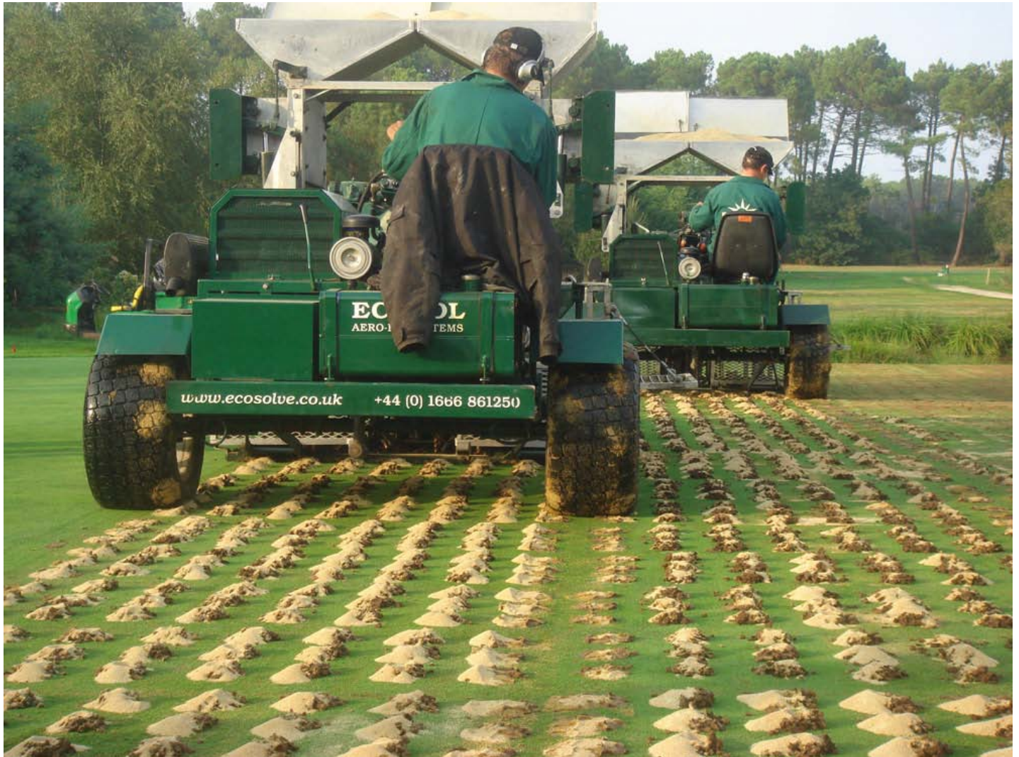
Les deux "carotteuses" en action
